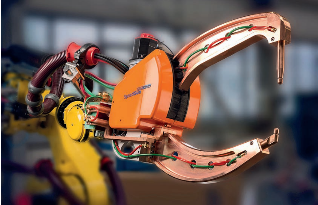
Von Lewa Attendorn entwickelte Schweißroboter-Zange
