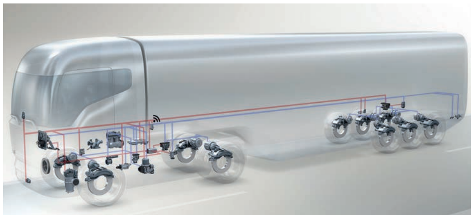
Modernes LKW-Bremssystem von Knorr Bremse
